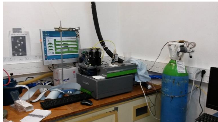
Fig. 2 : Vue de l'installation de l'instrument de mesure de la composition isotopique de la vapeur d'eau dans le bâtiment scientifique de prélèvement d'air de Pointe B.
