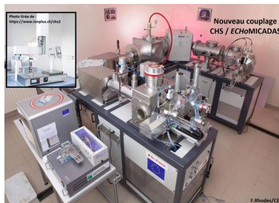
Fig : Vue d' ECHoMICADAS , spectromètre de masse par accélérateur et du périphérique « carbonate Handling system » CHS permettant de dater les carbonates par injection directe du \text{CO}_2 dans la source.
