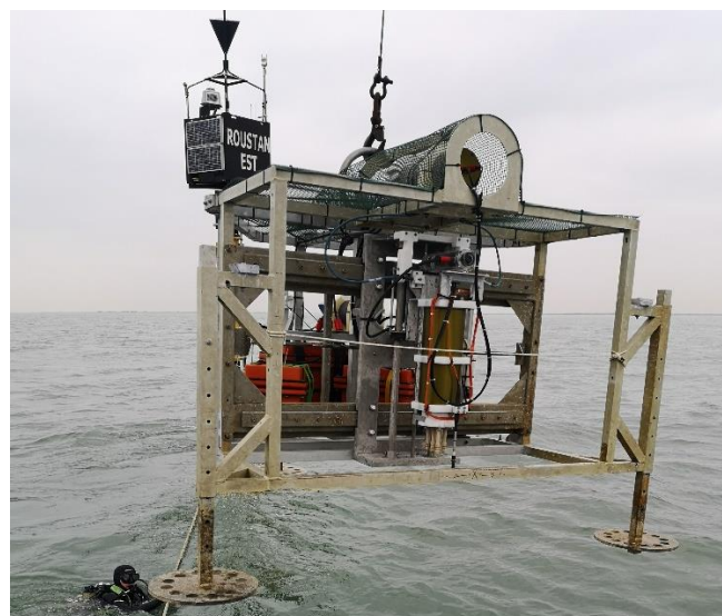
Fig 1 : Station Benthique de seconde génération en cours de déploiement à la station Mesurho (Bouée Roustan-Est)
