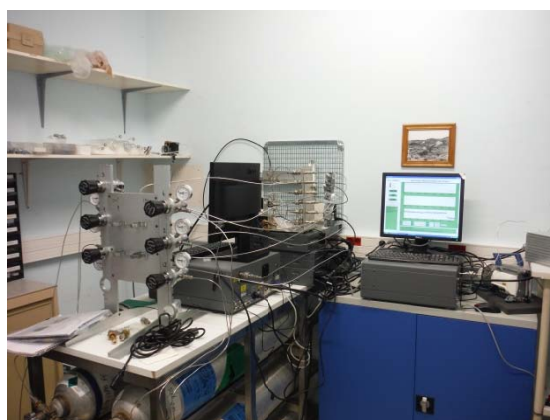
Dispositif expérimental de mesure des concentrations de gaz à effet de serre. © O. Llado
