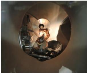
Pièce de verre d'un vitrail de la cathédrale d'Angers (vers 1190-1210), installée dans la chambre à vide de la station expérimentale de la ligne de lumière LUCIA au Synchrotron SOLEIL.
