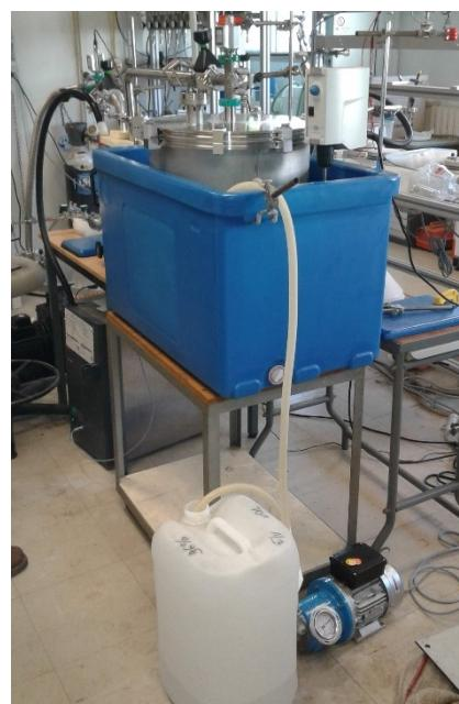
*Figure: Système d'extraction de l'air de grosses quantités de glace pour mesure de la composition isotopique du krypton et datation absolue des carottes de glace.*
