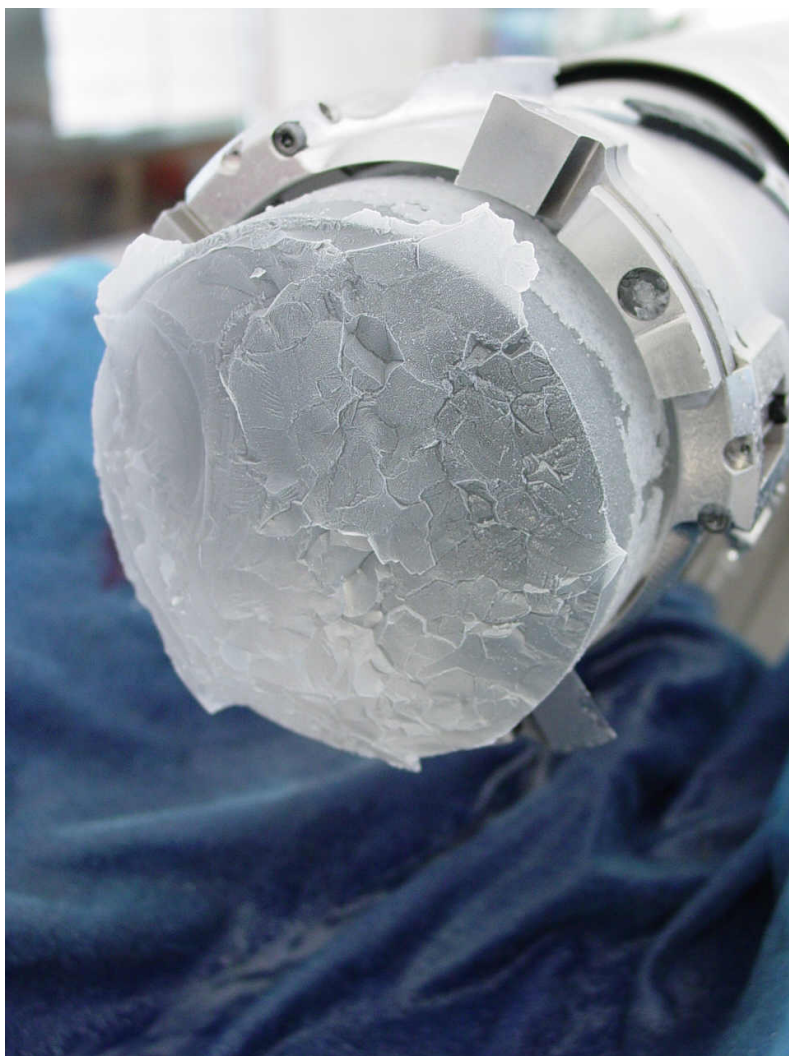
Une carotte de glace extraite d'un forage à Concordia/Dome C dans le cadre du projet EPICA. © CEA-IPEV
